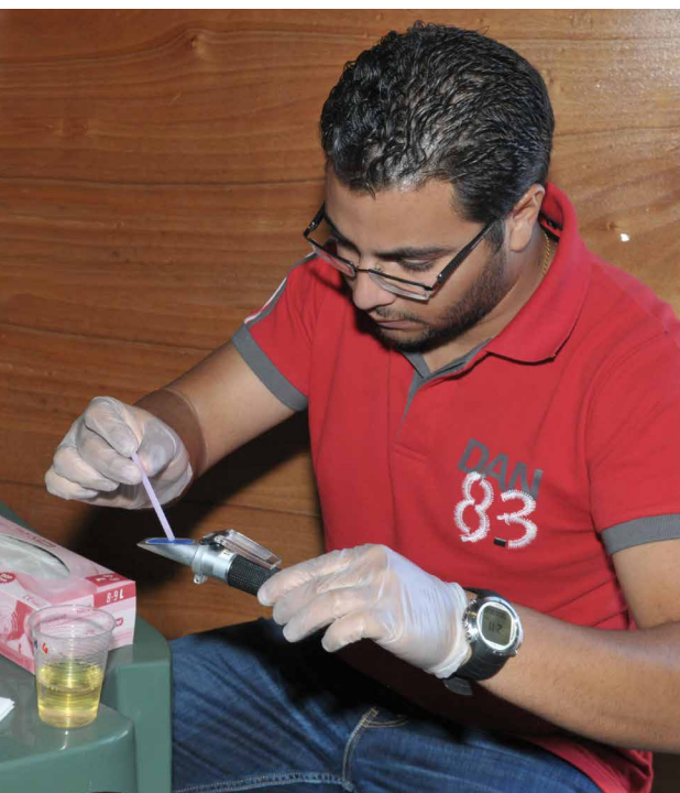
Un ricercatore DAN Europe esegue il test di densità urinaria durante un evento DAN Research. Questo test determina il peso specifico delle urine, il quale dipende dallo stato di idratazione del subacqueo
